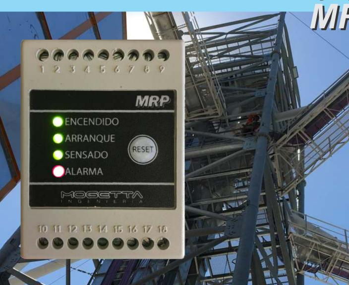
De tamaño reducido para montaje sobre riel DIN, simple instalación y manejo. En el panel se muestra toda la información sobre el funcionamiento y el diagnóstico. Este dispositivo permite verificar la correcta rotación de los diferentes sistemas de movimiento de cereales de la planta, detectando patinaje de las correas de las norias, atoramiento de roscas extractoras, reddlers, etc.
